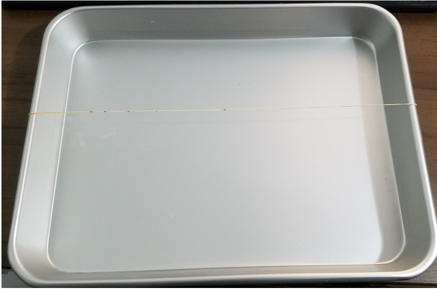
図 4: アルミニウム製のバットに輪ゴムを取り付け、養生テープで両端を固定したもの。弦長の \frac{1}{2} , \frac{1}{3} , \frac{1}{4} , \frac{1}{5} , \frac{1}{6} の位置に印をつけてある。
